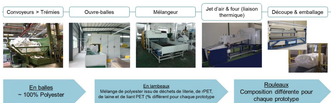
Figure 7 : Processus de fabrication des isolants
